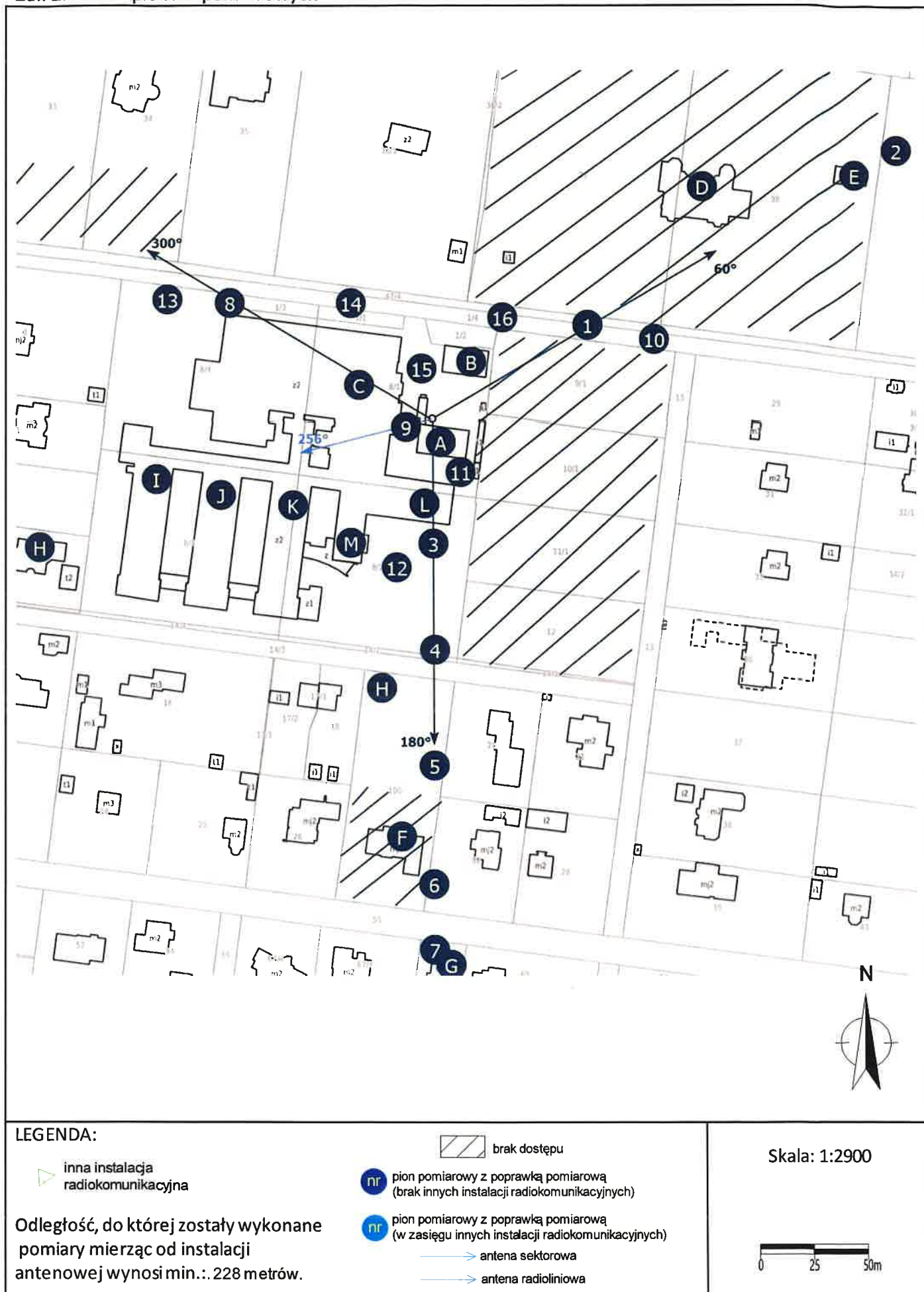
Załącznik 2. Widok pionów pomiarowych
