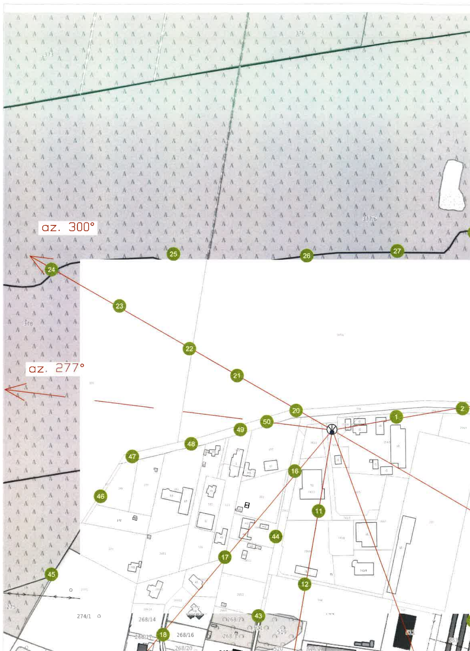
Rys.1 Lokalizacja pionów pomiarowych
