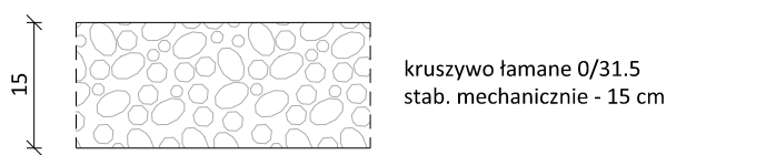
KONSTRUKCJA NAWIERZCHNI POBOCZA skala 1:10
