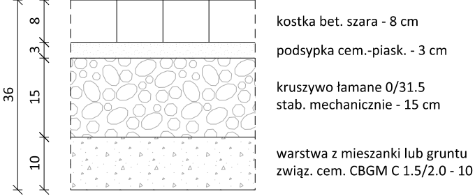
KONSTRUKCJA NAWIERZCHNI PIERSIENIA RONDA
