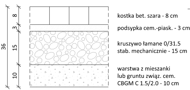
KONSTRUKCJA NAWIERZCHNI ZJAZDU skala 1:10
