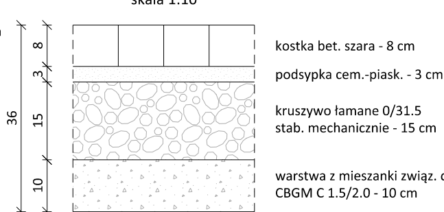
KONSTRUKCJA NAWIERZCHNI CHODNIKA skala 1:10
